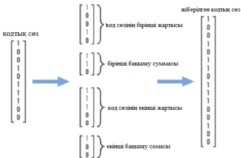
2.7-сурет – CRC кодерінің жұмыс принципі
