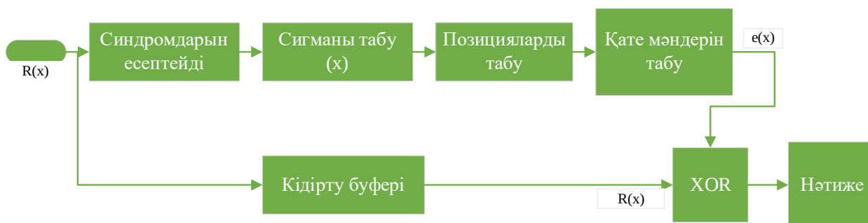
2.3-сурет – БЧХ сигналды декодтаудың құрылымдық схемасы
